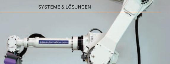
Bild 1 | Eine am Roboterarm installierte Kamera, ein KI-basiertes 3D-Vision-System und ein anwendungsspezifischer Sauggreifer sind die wesentlichen Komponenten der von Vision On Line und ASA Automation realisierten 3D-Picking Lösung.
